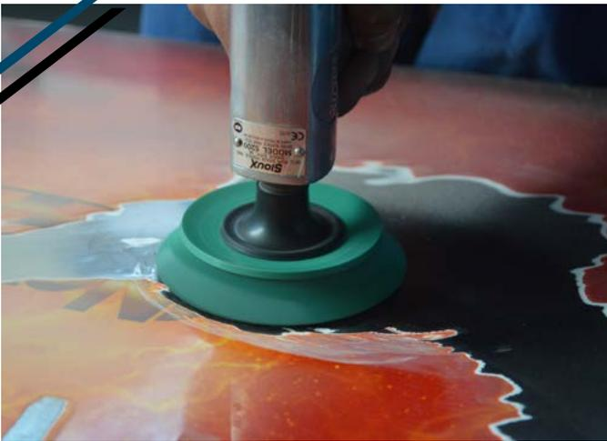
**Pieza de trabajo:** Lámina de acero con primer, pintura y barniz.
