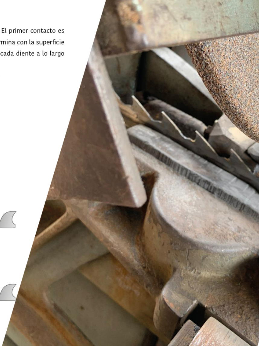
Secuencia de perfilado de sierra cinta
